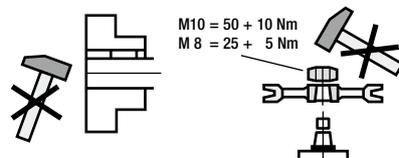
Les surfaces d'étanchéité ne doivent pas être endommagées.
